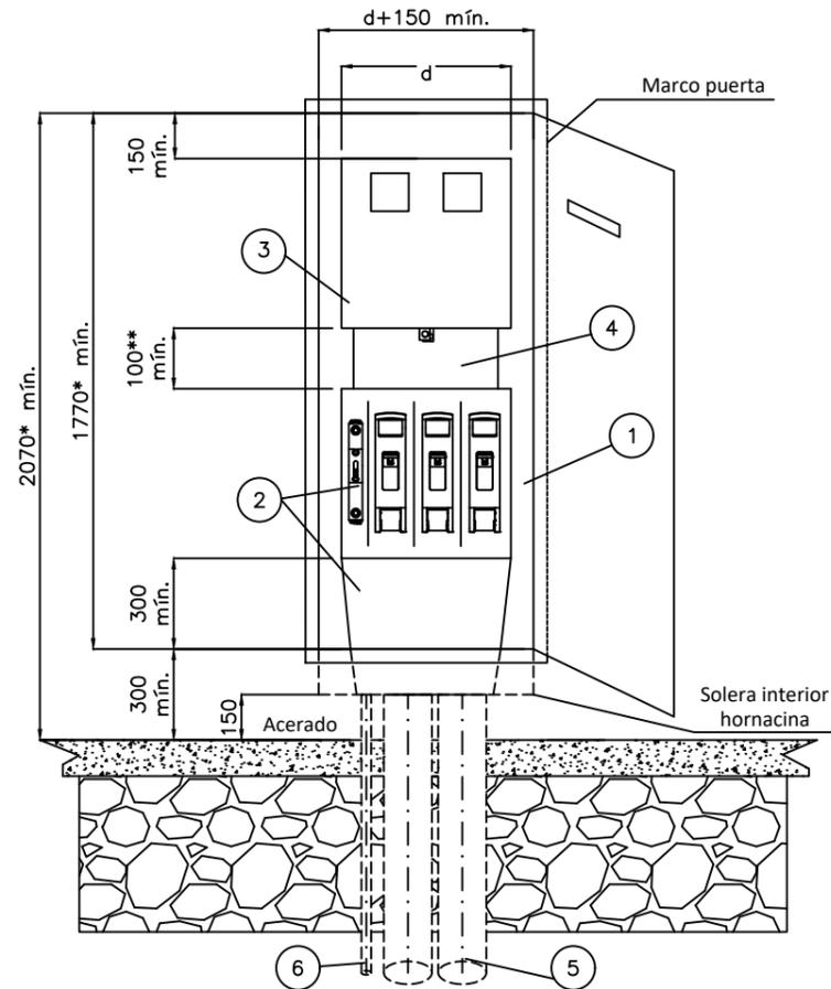
CAJA SECCIONAMIENTO TIPO ANCHA
