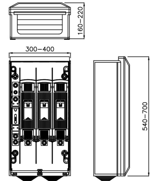
ESQUEMA CAJA SECCIONAMIENTO
