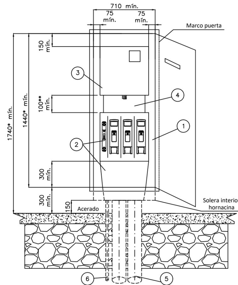
CAJA SECCIONAMIENTO TIPO ANCHA
