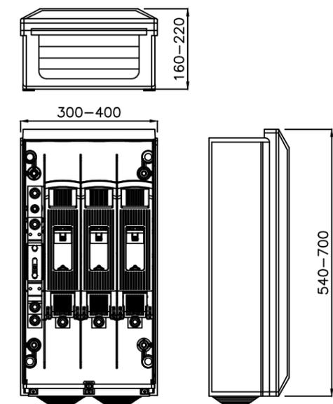
\* Cota mínima considerando caja de seccionamiento tipo ancha
