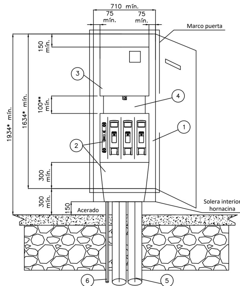
**CAJA SECCIONAMIENTO TIPO ANCHA**
