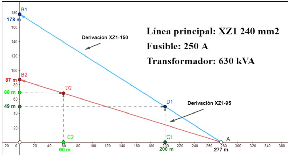
La longitud máxima de una derivación con cable XZ1-150 mm<sup>2</sup> conectada a 200 metros del CT es de 49 metros.
