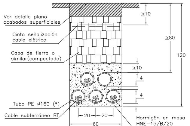
(\*) En canalizaciones mixtas, los tubulares para el cable de media tensión serán de  $\varnothing 200$  mm (excepto en suelo rural donde podrán ser de  $\varnothing 160$  mm).
