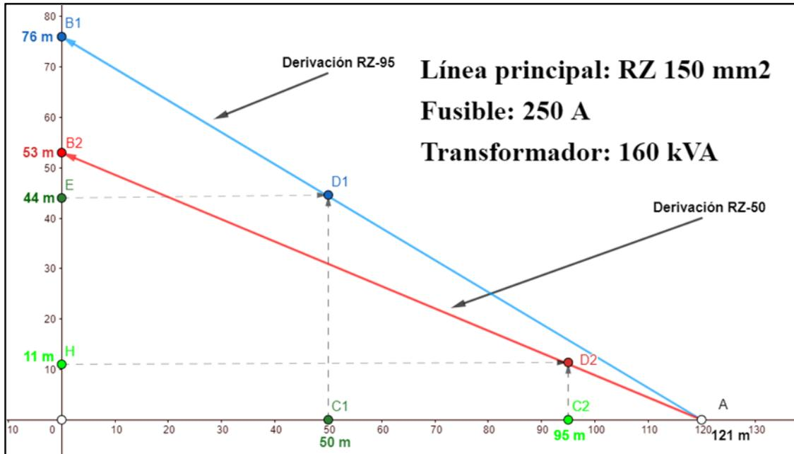
La longitud máxima de una derivación con cable RZ-95 mm<sup>2</sup> conectada a 50 metros del CT es de 44 metros.
