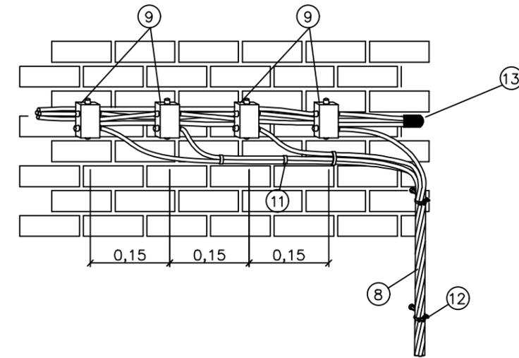
**SISTEMA DE UNIÓN MANGUITO - CONDUCTOR**
