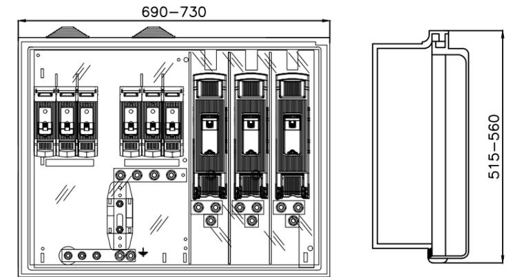
ESQUEMA CAJA SECCIONAMIENTO
