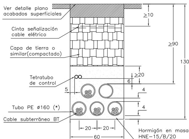
(\*) En canalizaciones mixtas, los tubulares para el cable de media tensión serán de  $\varnothing 200$  mm (excepto en suelo rural donde podrán ser de  $\varnothing 160$  mm).
