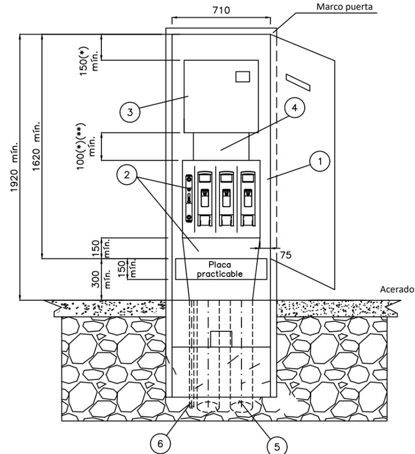
**CAJA SECCIONAMIENTO TIPO ANCHA**
