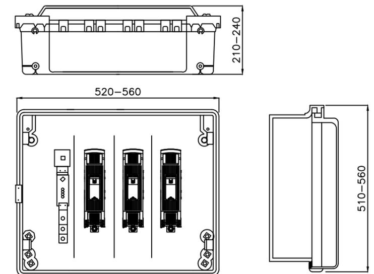
**CAJA SECCIONAMIENTO TIPO ESTRECHA**
