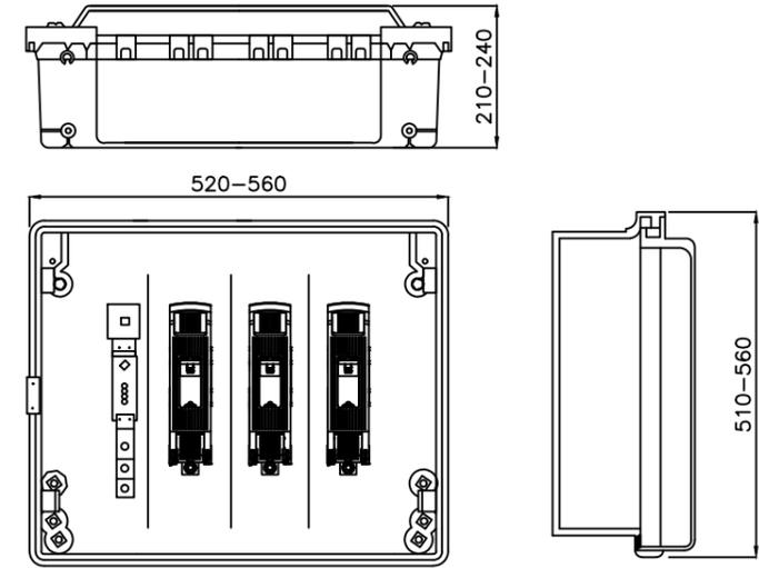
**CAJA SECCIONAMIENTO TIPO ESTRECHA**
