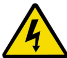
Figura 7. Símbolo "ADVERTENCIA DE RIESGO ELÉCTRICO"
