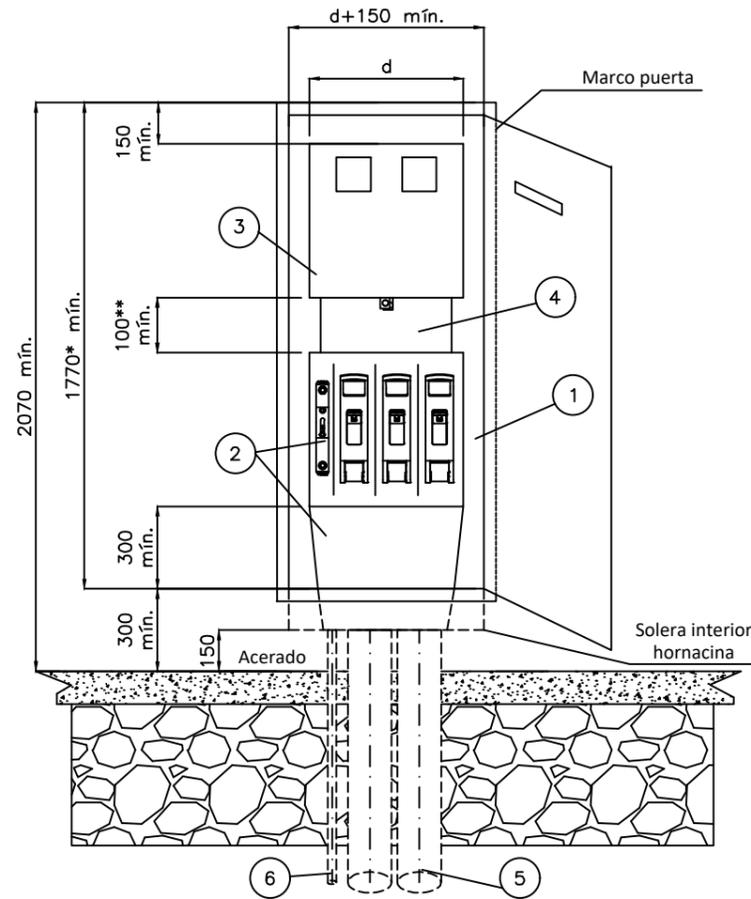
CAJA SECCIONAMIENTO TIPO ANCHA
