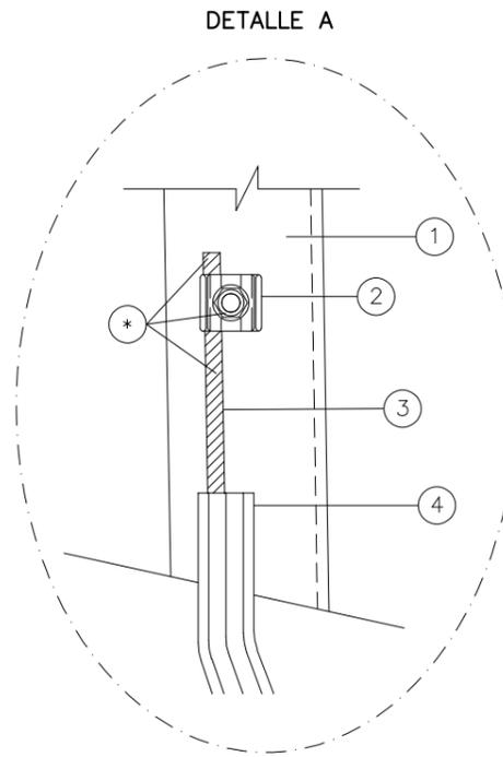
**CONECTORES AMPACT PARA ENLACES Cu/Cu Y Cu/PICA EN PUESTA A TIERRA**
