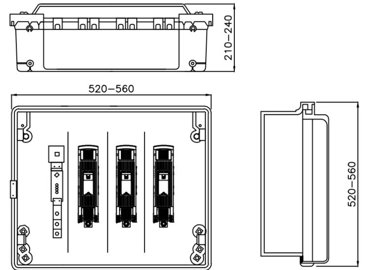
CAJA SECCIONAMIENTO TIPO ESTRECHA
