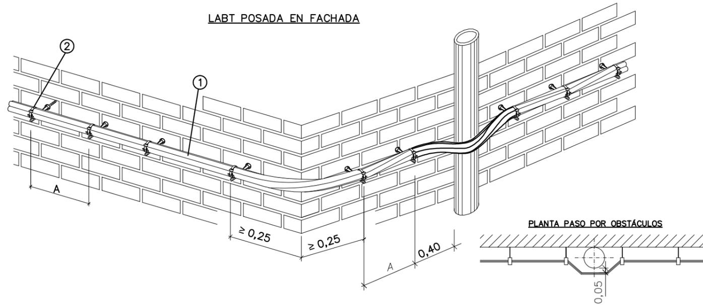
Distancia entre abrazaderas en función de la sección del cable RZ
