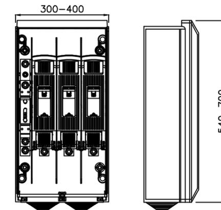
\* Cota mínima considerando caja de seccionamiento tipo ancha
