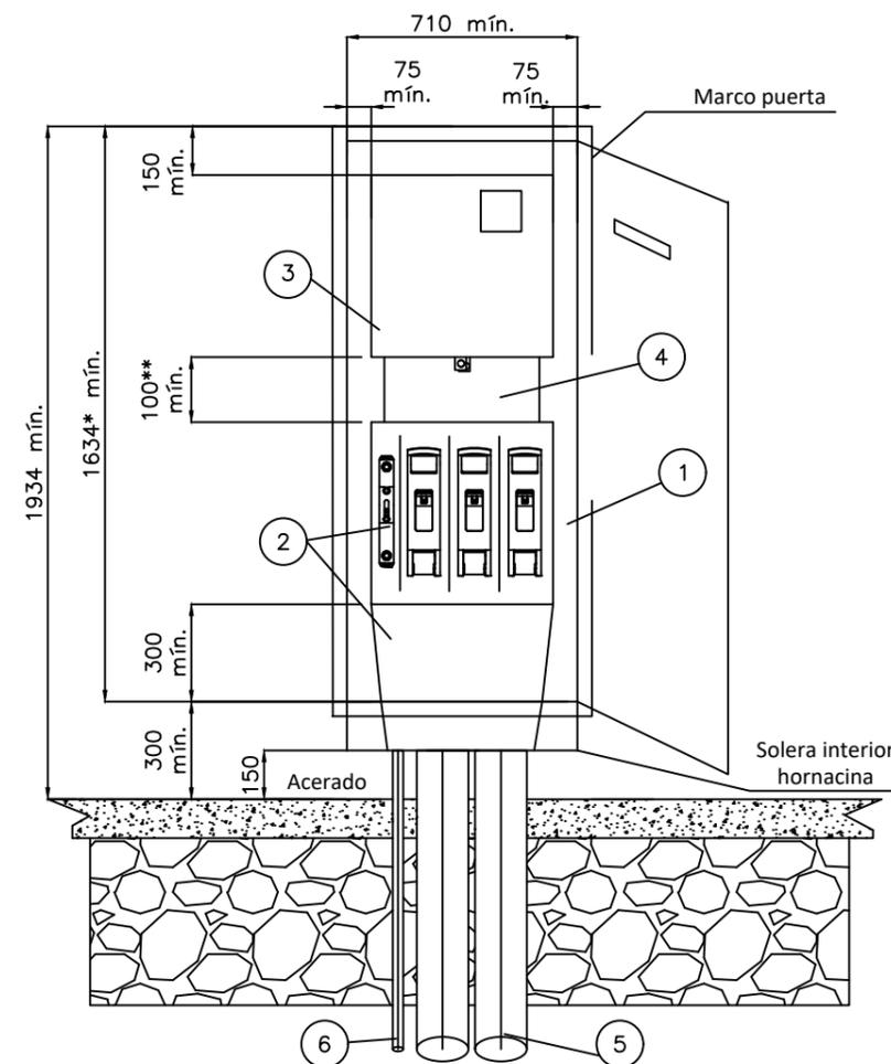
**CAJA SECCIONAMIENTO TIPO ANCHA**
