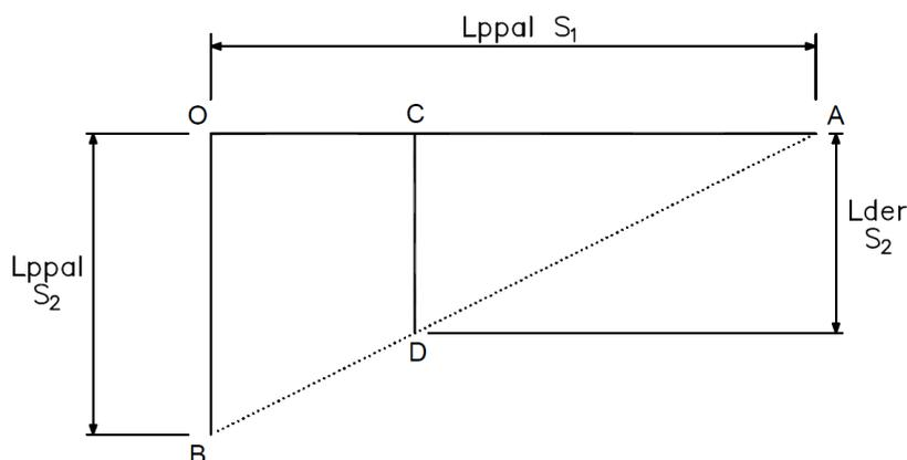
$L_{ppal}(S_1) = \overline{OA}$ , longitud máxima de una línea principal, de sección  $S_1$ , protegida contra cortocircuitos por un dispositivo de protección instalado en cabecera (O).
