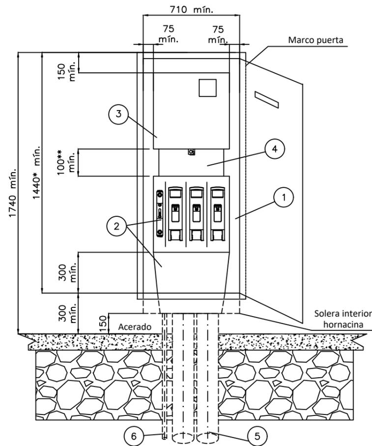
**CAJA SECCIONAMIENTO TIPO ANCHA**
