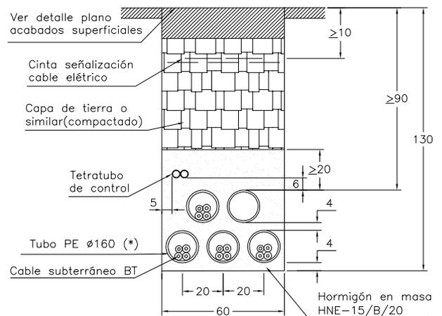
(\*) En canalizaciones mixtas, los tubulares para el cable de media tensión serán de  $\varnothing 200$  mm (excepto en suelo rural donde podrán ser de  $\varnothing 160$  mm).
