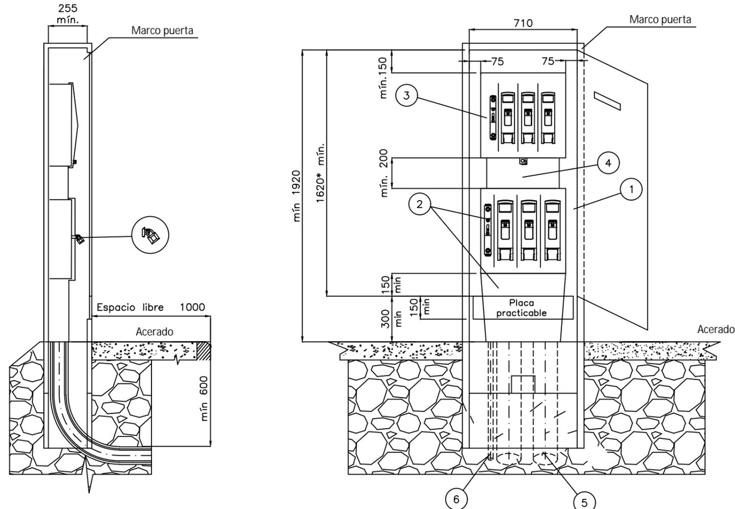
CAJA SECCIONAMIENTO TIPO ANCHA
