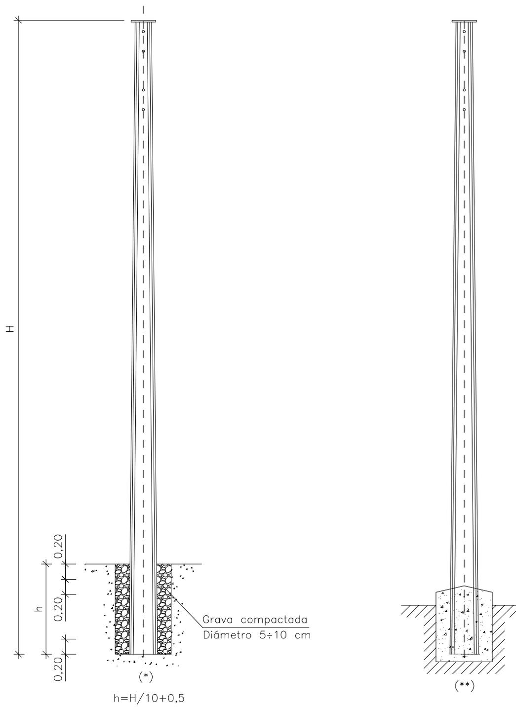
(\*) Cimentación exclusiva para apoyos de esfuerzo hasta 250 daN y K del terreno  $\leq 8 \text{ Kg/cm}^3$
