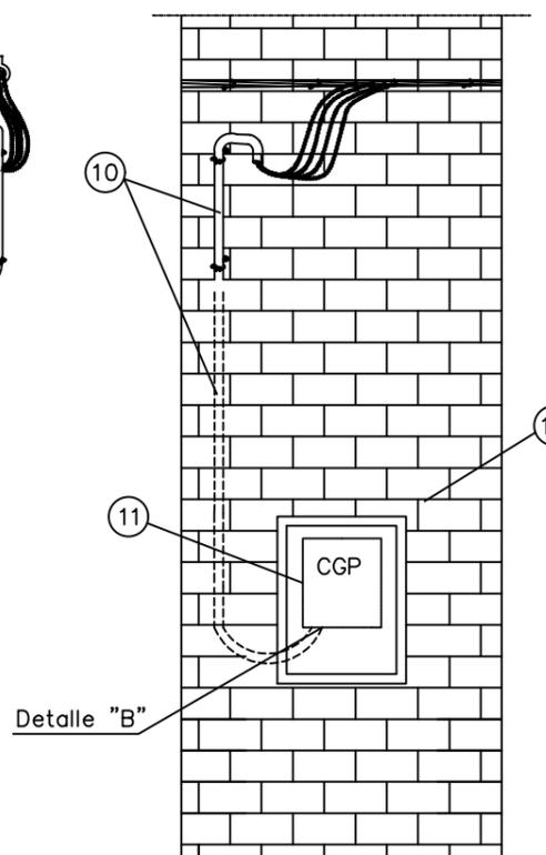
Canalización de la acometida bajo tubo (obligatoria su instalación en distancias inferiores a 2,50 m con respecto al nivel del suelo):
