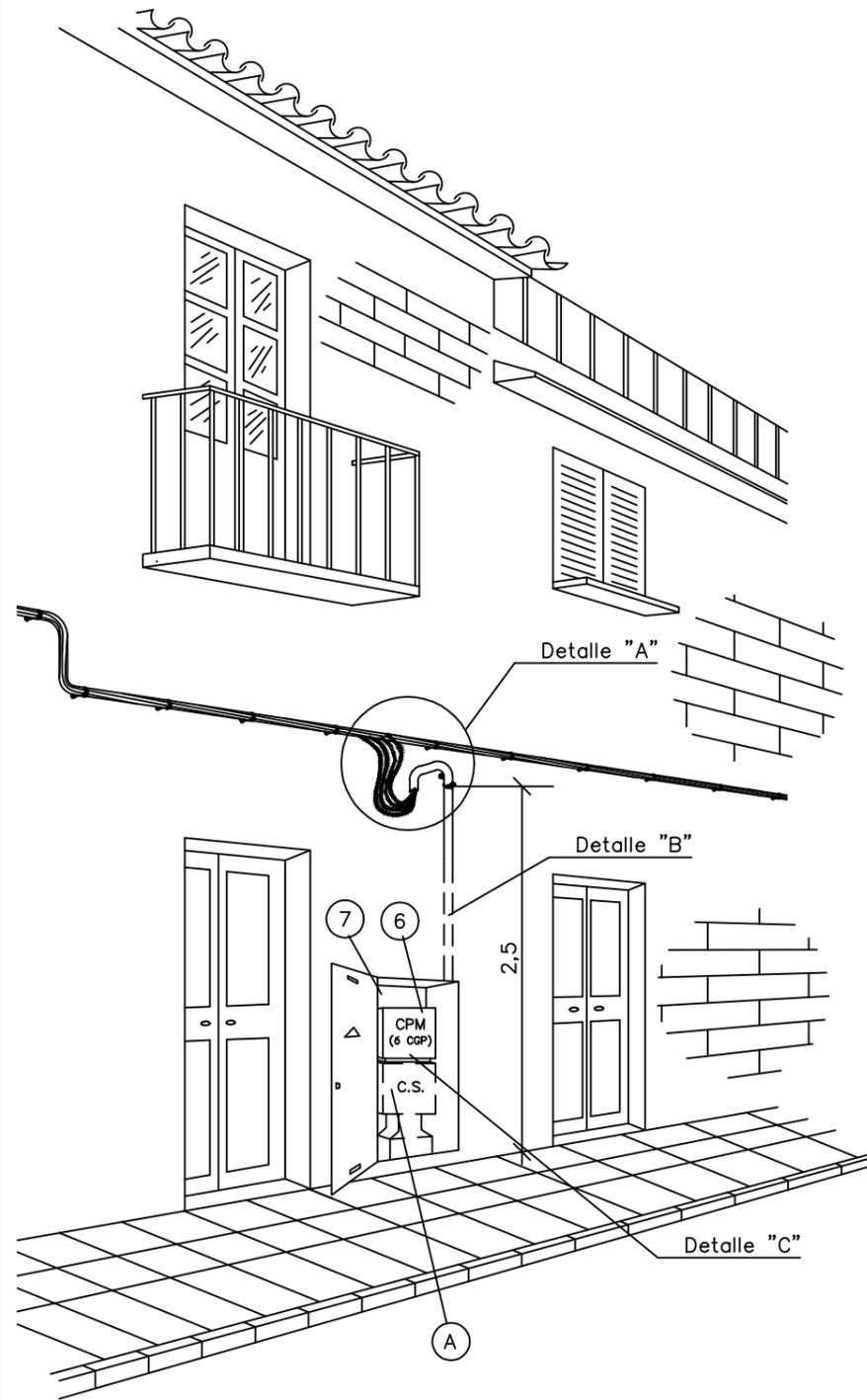
**A** Huevo en hornacina para colocar CS y canalización subterránea cuando este previsto el soterramiento de la red de distribución. Dimensiones según NRZ002020.
