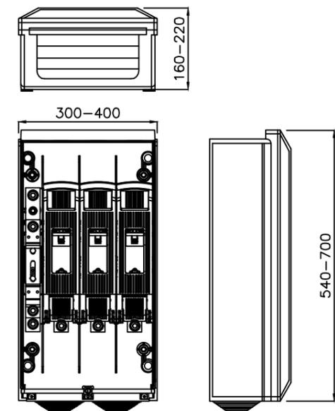
ESQUEMA CAJA SECCIONAMIENTO
