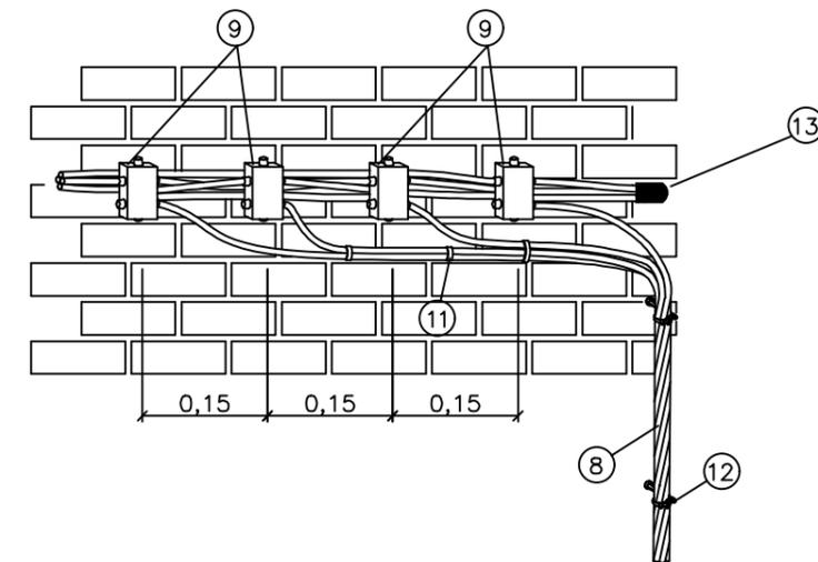
**SISTEMA DE UNIÓN MANGUITO - CONDUCTOR**
