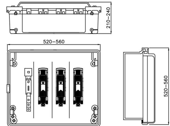
**CAJA SECCIONAMIENTO TIPO ESTRECHA**
