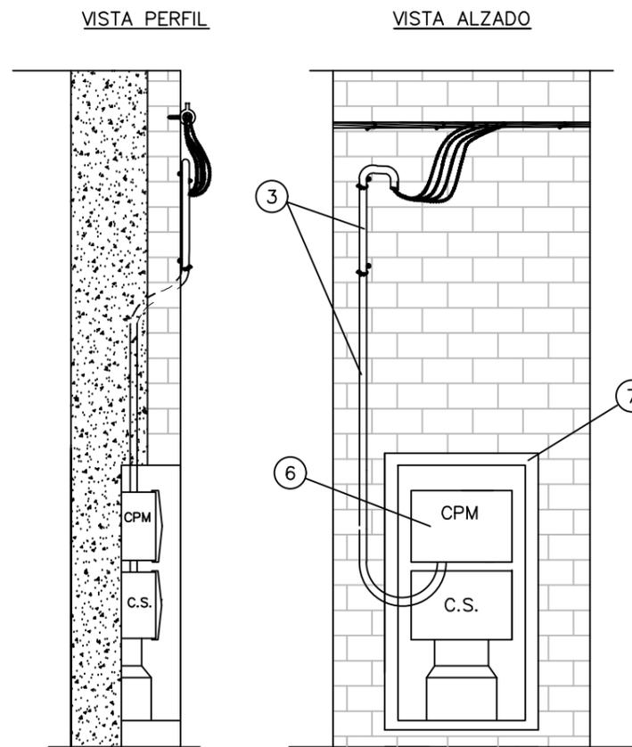
Canalización de la acometida bajo tubo (obligatoria su instalación en distancias inferiores a 2,50 m con respecto al nivel del suelo):
