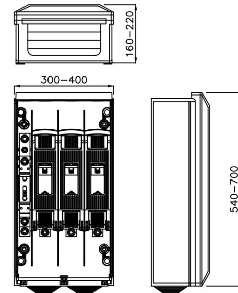
**ESQUEMA CAJA SECCIONAMIENTO**
